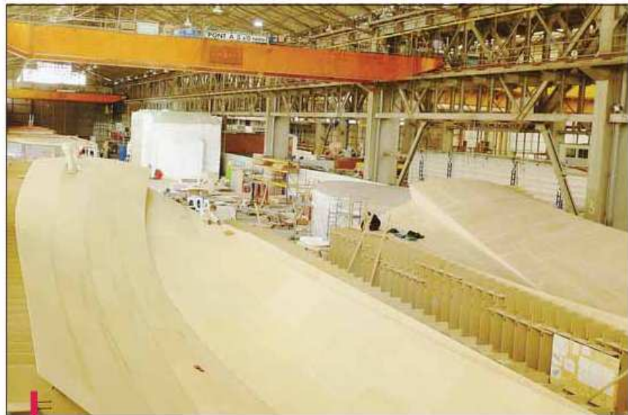
Les deux demi-coques de l' André-Malraux seront bientôt placées en atmosphère protégée sous un cocon de plastique translucide.
