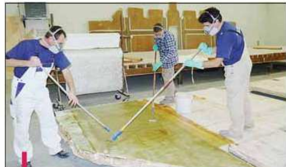
Dans la "salle composite", les cloisons du bateau sont recouvertes de résine.
