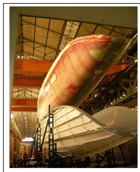
Démoulage de la coque du Nahéma 120
